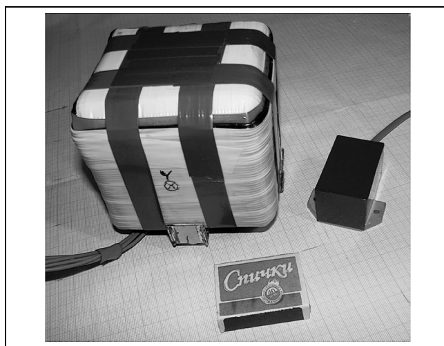
Рис. 4. Электрофизические компоненты магнитного трекера наשלемного применения
