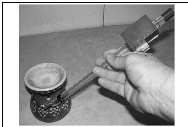
Рис. 9. Дигитайзер 3D-поверхности, УИП на удлинителе, на конце которого тонкий щуп касается поверхности сканируемого изделия в требуемой точке, ГМП не показан
