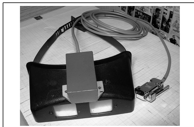
Рис. 7. Устройство для выбора и позиционирования объектов на столе или на экране
